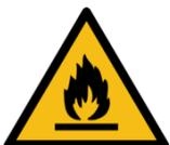
**ISO7010 W021 Apparecchiatura contenente gas infiammabile R290**
